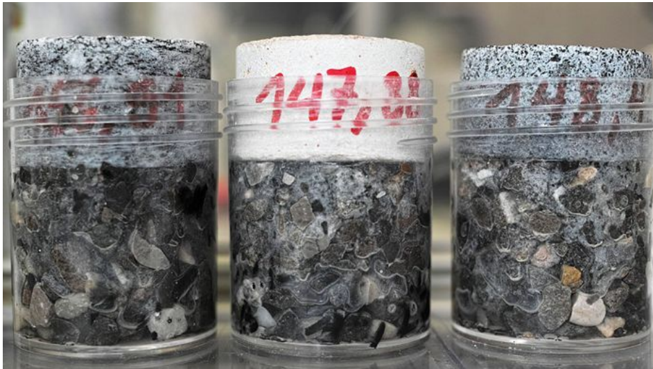
Abbildung 18: Aufbau zur Bestimmung der Saugfähigkeit am Splitt. Die getrocknete Natursteinprobe (von Links nach Rechts der Cresciano, der Dietfurter und der Padang) wird gewogen und danach auf einem mit nassem Splitt gefüllten Becher verlegt. Die Saugfähigkeit wird als Differenz zwischen Feuchtgewicht und Trockengewicht bestimmt.
